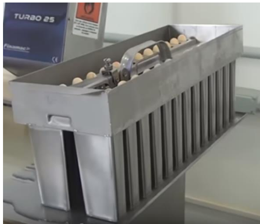
Figura 4 - Forma de picolés do tipo Mich. Fonte: www.finamac.com.br
